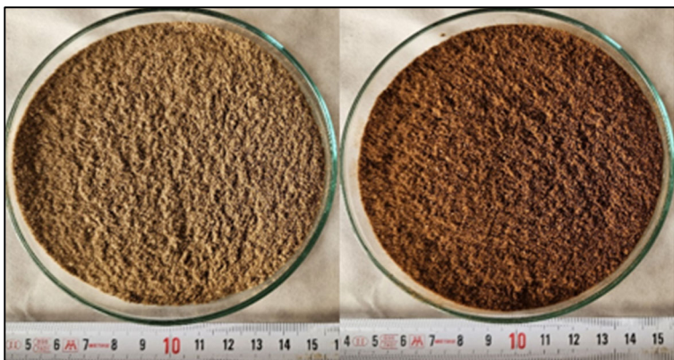
Obr. 2: Změna vzorku při ponechání v sušárně po dobu 168 hodin
